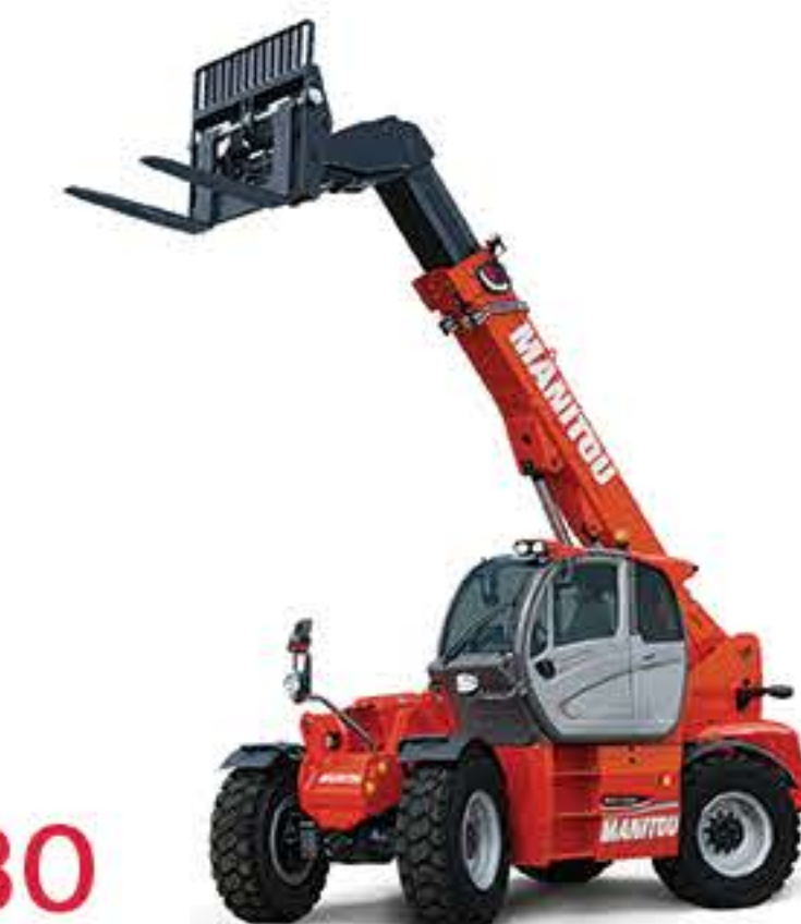
MT 1840 SLT 4,000kg / 17.5m Fork Carriage
