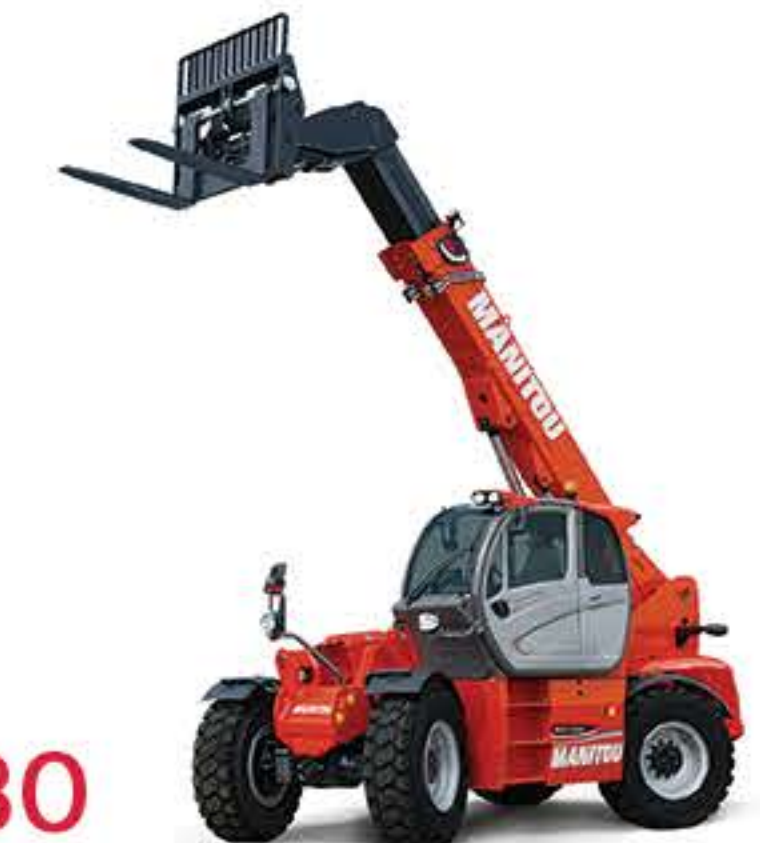
MT 1840 SLT 4,000kg / 17.5m Fork Carriage
